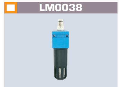
LM0038 Lubrificateur Oiler Cuve métal / Metal cup Débit d'huile réglable / Adjustable oil flow Débit d'air / Air flow : 4300 l/mn Pression / Pressure : 0 - 12 bar Entrée / Inlet : 3/8" F Sortie / Outlet : 3/8" F
