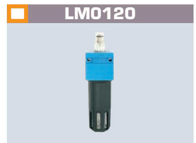
LM0120 Lubrificateur Oiler Cuve métal / Metal cup Débit d'huile réglable / Adjustable oil flow Débit d'air / Air flow : 4300 l/mn Pression / Pressure : 0 - 12 bar Entrée / Inlet : 1/2" F Sortie / Outlet : 1/2" F
