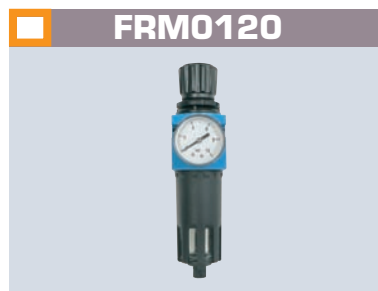
FRM0120 Détendeur + filtre Pressure reducer + filter Cuve métal / Metal cup Manomètre / Gauge : Ø 50 mm Débit d'air / Air flow : 2600 l/mn Pression / Pressure : 0 - 12 bar Entrée / Inlet : 1/2" F Sortie / Outlet : 1/2" F
