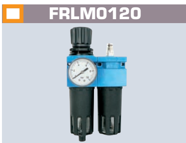
FRLM0120 Détendeur + filtre + lubrificateur Pressure reducer + filter + oiler Cuve métal / Metal cup Débit d'huile réglable / Adjustable oil flow Manomètre / Gauge : Ø 50 mm Débit d'air / Air flow : 2250 l/mn Pression / Pressure : 0 - 12 bar Entrée / Inlet : 1/2" F Sortie / Outlet : 1/2" F
