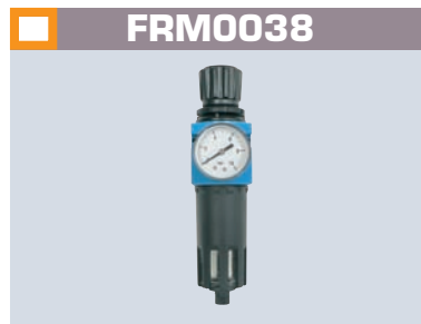
FRM0038 Détendeur + filtre Pressure reducer + filter Cuve métal / Metal cup Manomètre / Gauge : Ø 50 mm Débit d'air / Air flow : 2600 l/mn Pression / Pressure : 0 - 12 bar Entrée / Inlet : 3/8" F Sortie / Outlet : 3/8" F
