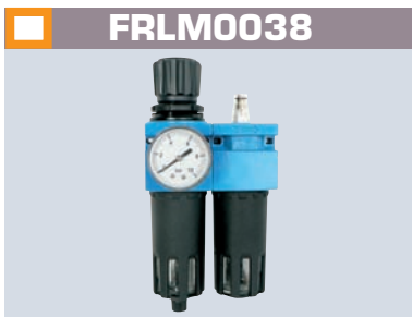
FRLM0038 Détendeur + filtre + lubrificateur Pressure reducer + filter + oiler Cuve métal / Metal cup Débit d'huile réglable / Adjustable oil flow Manomètre / Gauge : Ø 50 mm Débit d'air / Air flow : 2250 l/mn Pression / Pressure : 0 - 12 bar Entrée / Inlet : 3/8" F Sortie / Outlet : 3/8" F
