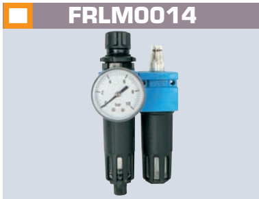
FRLM0014 Détendeur + filtre + lubrificateur Pressure reducer + filter + oiler Cuve métal / Metal cup Débit d'huile réglable / Adjustable oil flow Manomètre / Gauge : Ø 40 mm Débit d'air / Air flow : 600 l/mn Pression / Pressure : 0 - 12 bar Entrée / Inlet : 1/4" F Sortie / Outlet : 1/4" F
