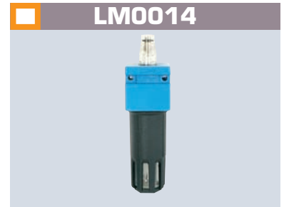
LM0014 Lubrificateur Oiler Cuve métal / Metal cup Débit d'huile réglable / Adjustable oil flow Débit d'air / Air flow : 1150 l/mn Pression / Pressure : 0 - 12 bar Entrée / Inlet : 1/4" F Sortie / Outlet : 1/4" F
