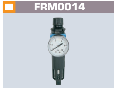
FRM0014 Détendeur + filtre Pressure reducer + filter Cuve métal / Metal cup Manomètre / Gauge : Ø 40 mm Débit d'air / Air flow : 700 l/mn Pression / Pressure : 0 - 12 bar Entrée / Inlet : 1/4" F Sortie / Outlet : 1/4" F
